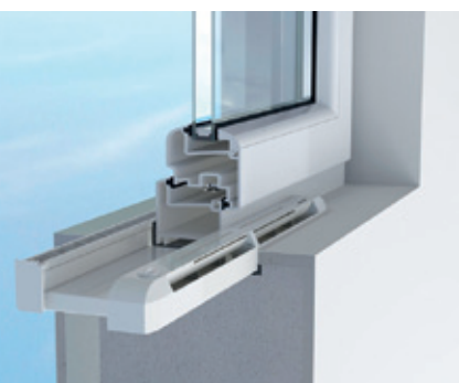
Nachströmung abgesaugter Luft in die Wohnung
